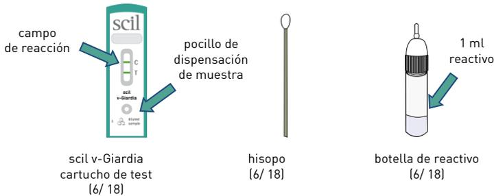
**Nota:** El campo de reacción muestra una línea verde en la zona de la línea de control y de test antes de utilizar el dispositivo de ensayo. Estos son indicadores de calidad y desaparecen al depositar el fluido de muestra durante la realización del ensayo.
